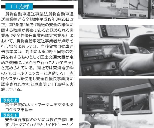
写真右側上 富士通製のネットワーク型デジタルタコグラフ運転装置 写真右側下 安全運行確保のためには投資を惜しまず、バックカメラとサイドビューカメラも装着している
